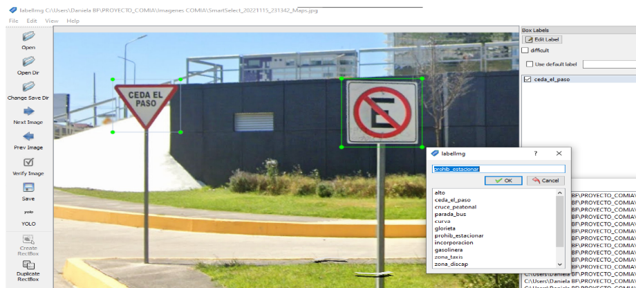
Fig. 3. Anotación de imágenes por medio de LabelImg.
